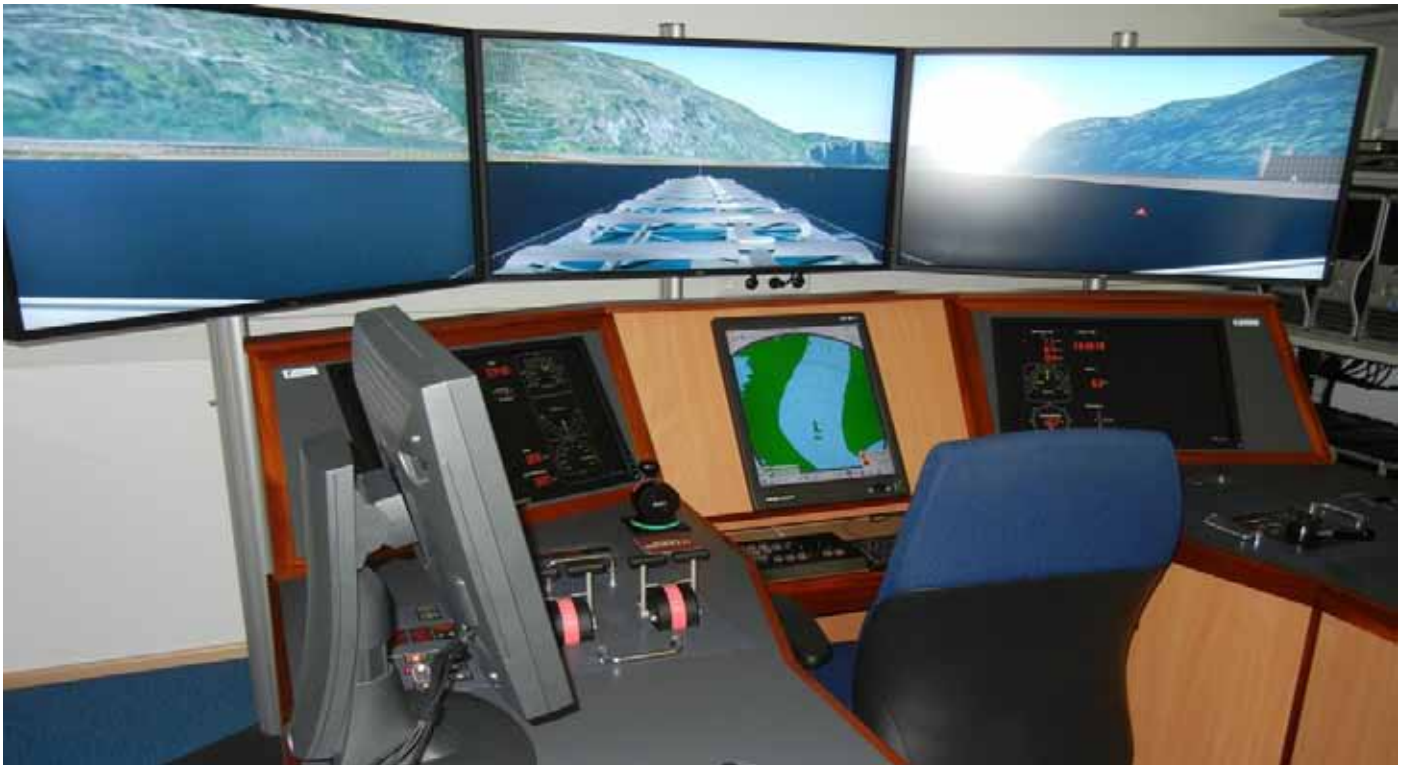
Foto: Schiffsführungssimulator in der BAW Karlsruhe
