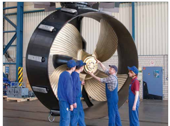
Fig. 2.3.1-4: Rudder propeller [SCHOTTEL]
