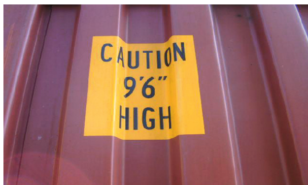
Fig. 2-3: Exact height indicated on the container side wall Abb. 2-3: Container-Seitenwand mit Angabe zur exakten Höhe
